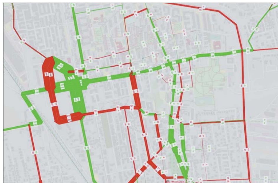
Diagram nr 2. Symulacja zmiany natężenia ruchu w godzinach popołudniowego szczytu po zamknięciu skrzyżowania ulic Dworcowej z Jana Pawła II i uruchomieniu połączenia ulic Nadarzyńskiej z Żeromskiego.
