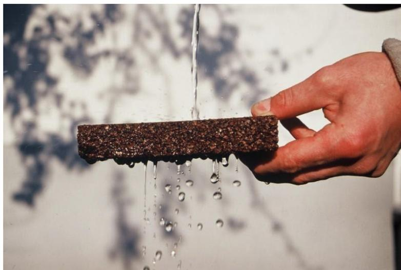
ryc. nawierzchnia przepuszczalna typu Terraway sugerowana do zastosowania dla głównych alei parkowych
