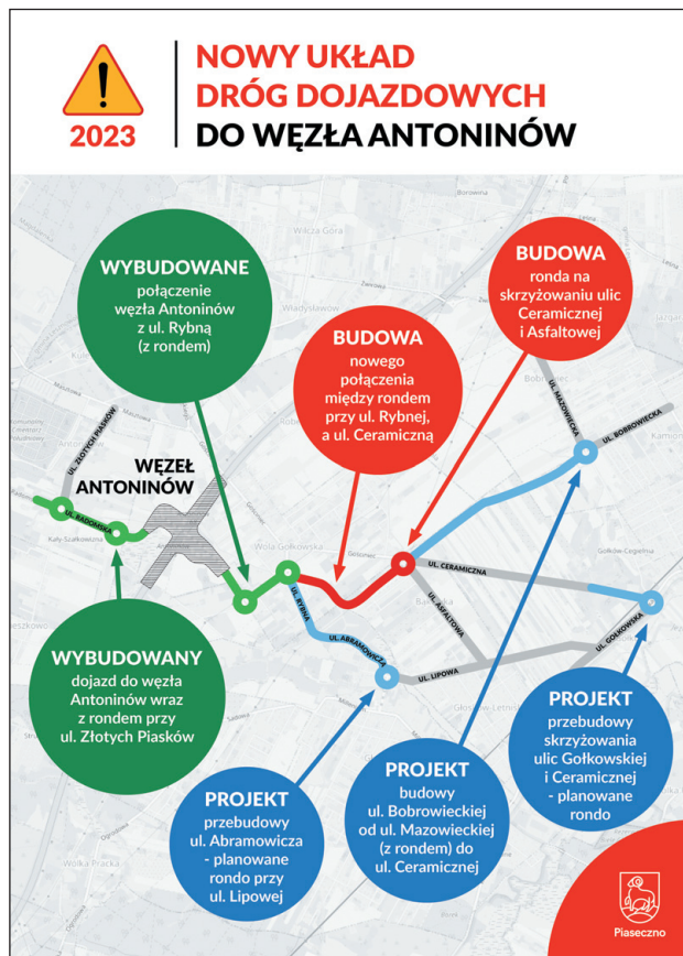
Układ dróg dojazdowych do węzła Antoninów na trasie S7 z uwzględnieniem wybudowanej, budowanej oraz projektowanej infrastruktury drogowej Wizualizacja URZĄD MIASTA I GMINY PIASECZNO
